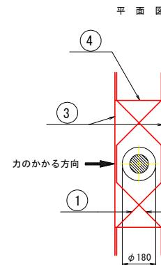
ガードレール補強筋(Gr-C-2B-S用)
